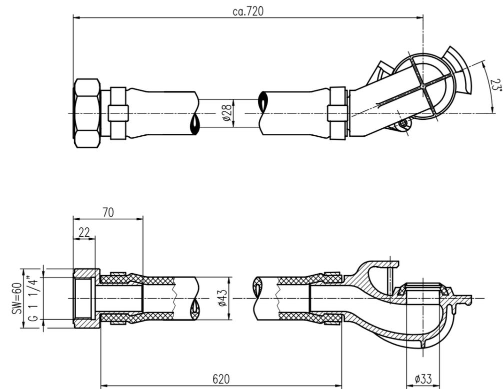
Prüfung: Auf Dichtheit – Prüfdruck 15 bar
